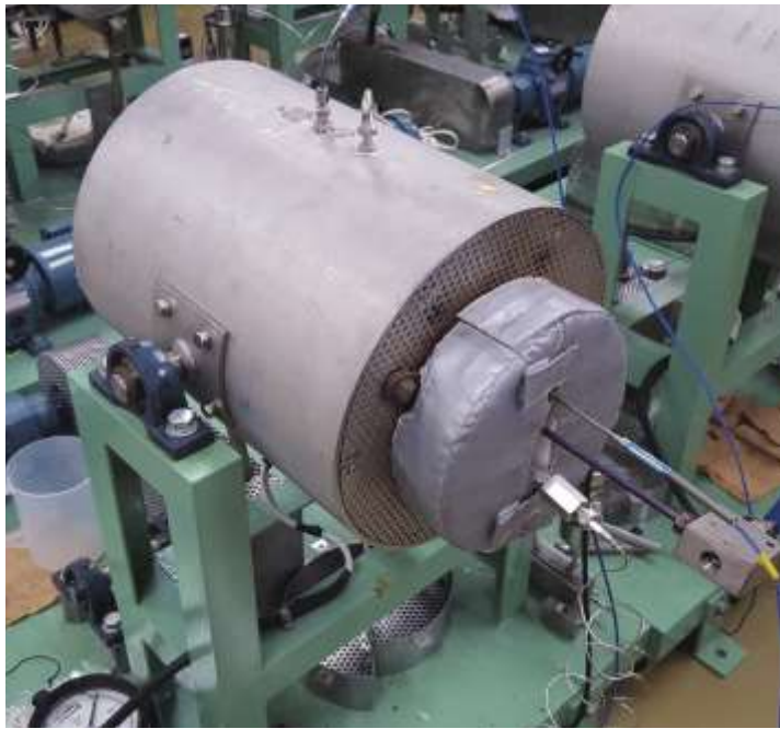
図2 エンケラドスの熱水環境を再現した高温・高圧に耐性のある反応容器。
