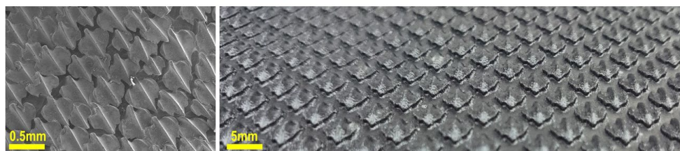
図1：サメ肌の表面 （左：実際のサメ肌、右：本研究の人工サメ肌）
