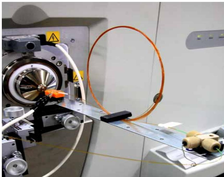
図.モノリス型シリカキャピラリーカラム (350 cm) を用いた LC-MS/MS 測定風景
